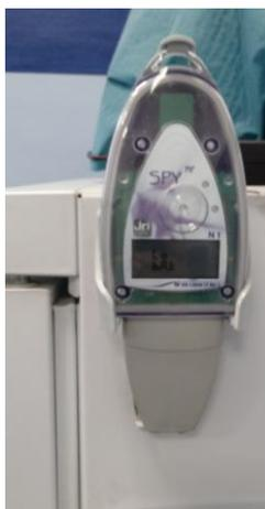
Tali apparecchi sono collegabili via wifi a Modem Wifi Ethernet di nome "Spy RF Model Ethernet"
