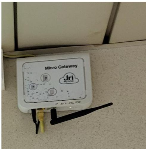
Questi micro Gateway sono Moduli trasmissione dotati di tecnologia LoRa su reti private. Il **Gateway LoRaTM** fornisce una copertura interna privata per i sensori connessi a lungo raggio LoRa® SPY. Installato su una rete Ethernet locale o in un'area di copertura 4G, invia le misurazioni all'applicazione di monitoraggio JRI MySirius. I dati raccolti possono essere inviati all'applicazione JRI MySirius e disponibili sul cloud JRI protetto o su un server locale privato.
