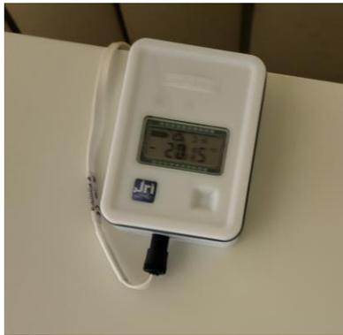
Quando parliamo di sensore di temperatura LoRa Spy in realtà parliamo di una ampia gamma di sensori multi-tecnologia per la temperatura e per l'umidità che deve essere scelto correttamente in base alle necessita. Tutti hanno batteria interna che dura circa 2 anni. Hanno la possibilità di avere un display della temperatura esterno. Questi apparecchi per la misurazione ed immagazzinamento dati di temperatura LoRa sono connessi con **Micro Gateway** specifici
